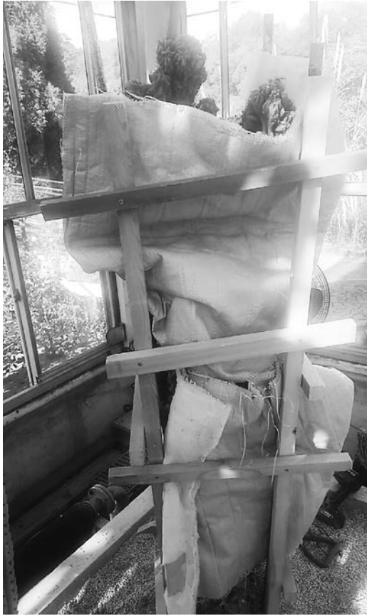
図7 岩石柱は運搬時には緩衝材で巻いて木枠で固定した (2022年10月)
