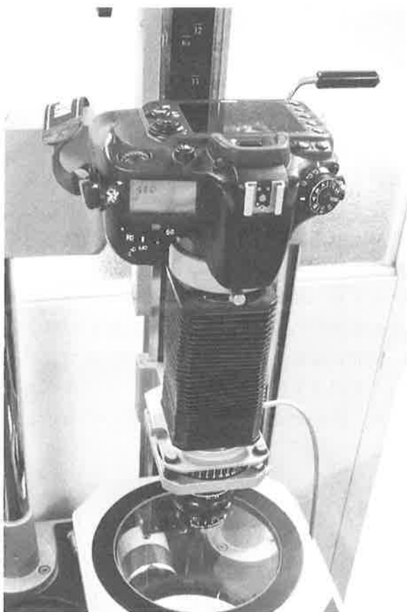
写真1 微細な種子の撮影に使った撮影台（ベローズと引き伸ばしレンズの組み合わせ）
